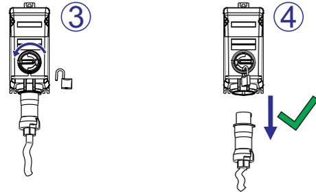
**Nota 1:** Quando o plugue estiver inserido na tomada e a chave seccionadora for acionada na posição ON, o intertravamento mecânico do plugue é acionado, não havendo possibilidade de remoção do plugue sem desenergizar a tomada evitando risco de acidente.
