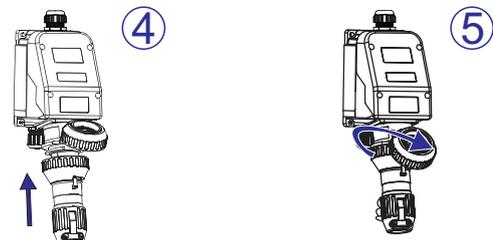
**Nota 1:** Quando o plugue estiver inserido na tomada e o plugue for rotacionado em sentido horário, o intertravamento mecânico do plugue é acionado, ficando impossibilitado a remoção do plugue sem desenergizar evitando risco de acidente.
